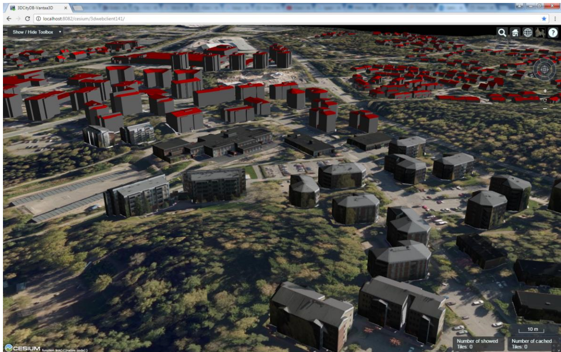
Kuva 15. Kuvakaappaus testivaiheessa olevasta selainpohjaisesta Cesium-esityksestä osasta Vantaan kaupunkimallia. Lähellä olevat rakennukset esiintyvät korkeimmalla tasolla, teksturoituna LOD2-tason mallina. Kauempana olevat kohteet ilman teksturointia punakattoisena LOD2-tasoisena. Aivan kauimmat kohteet ovat harmaita LOD1-tason laatikkomalleja.
