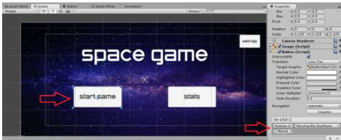
KUVA 14. Start game -nappi scenessä, sekä sen komponentit ja toiminnan määrittävä funktio valittuna.
