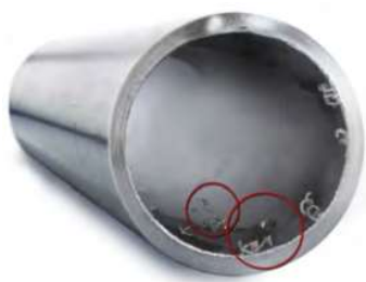
KUVA 6. Katkaisun jättämiä purseita (Norwegian Oil and Gas Association 2013, 26)
