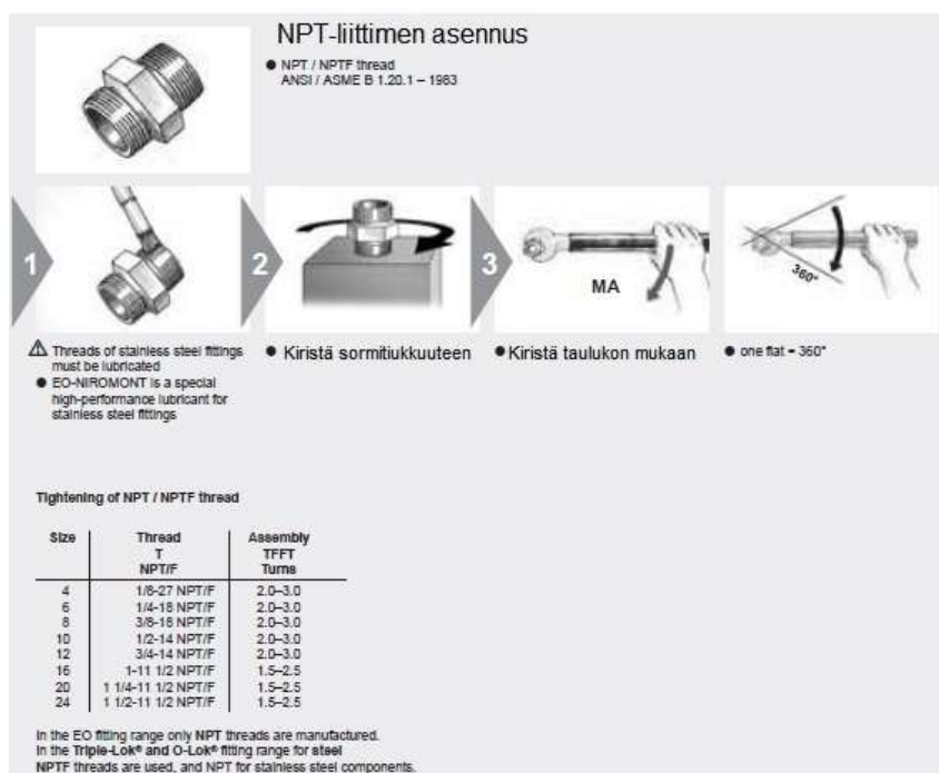
KUVA 13. NPT eli kartiokierteisen liittimen asennusohje (Parker 2007, F7)
