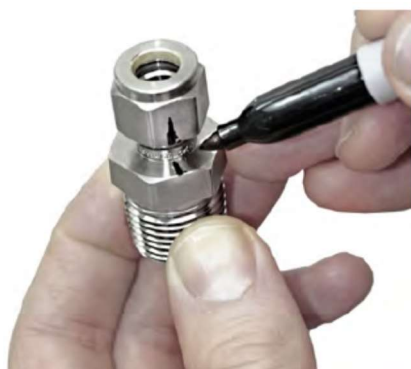
KUVA 36. Merkintä ennen työkalulla kiristämistä (Norwegian Oil and Gas Association 2013, 28)
