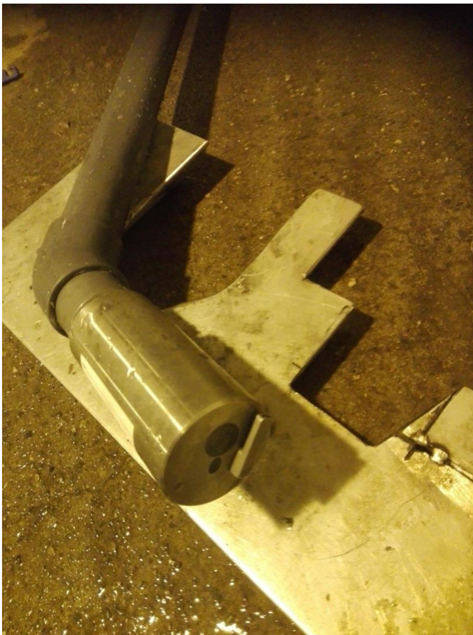
Kuva 4. Online-mittarin kiintoaineanturi puhdistettuna.
