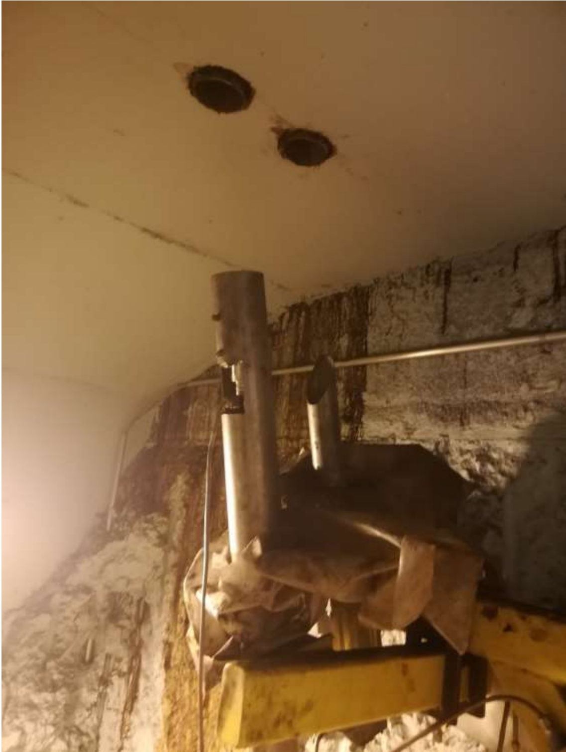
KUVA 23. Maan alle sijoitettu kahdennettu nauhan lämpötilamittaus ennen ke- lainta.
