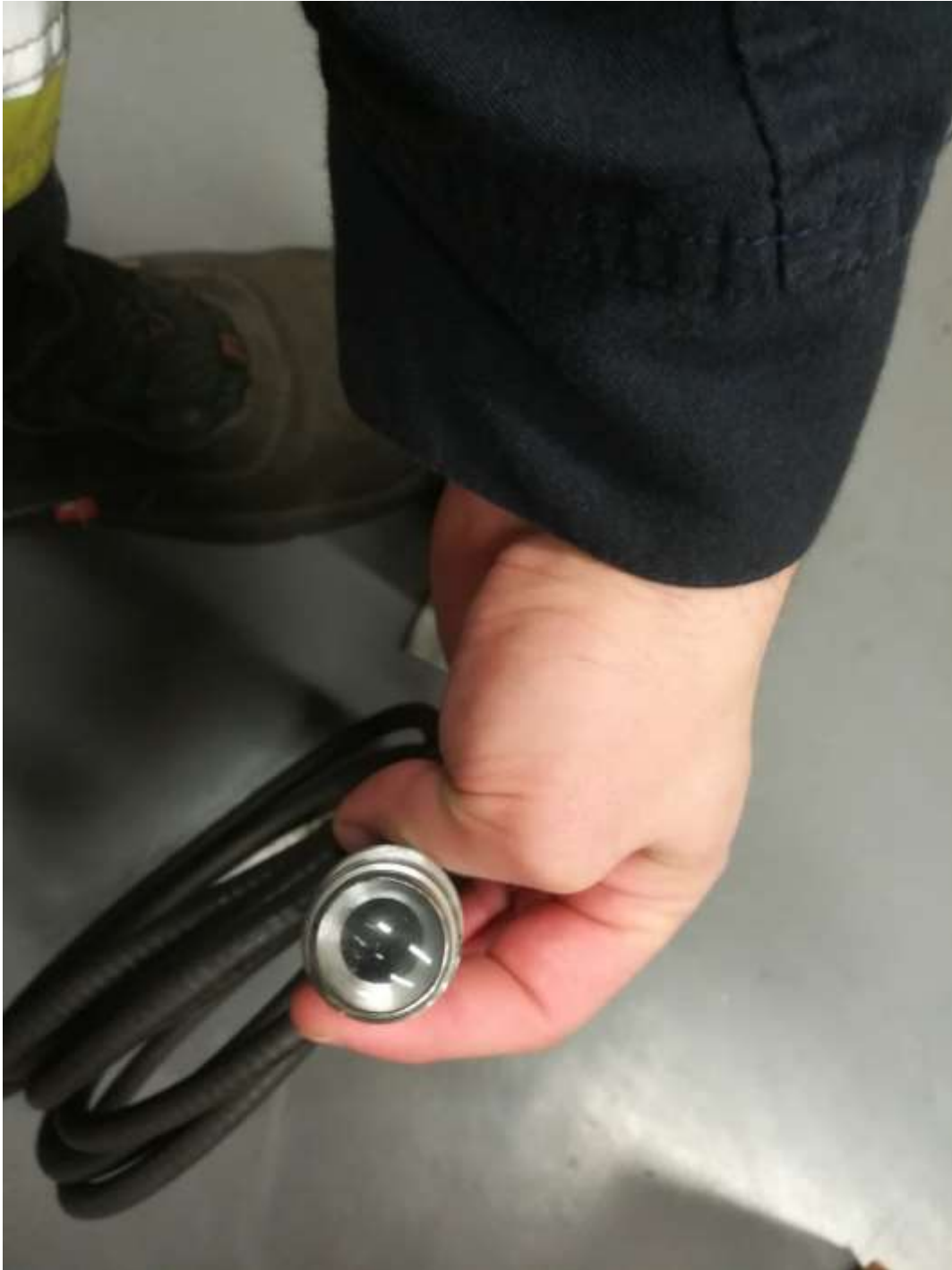
KUVA 12. Kuitupyrometrin optiikan linssi.
