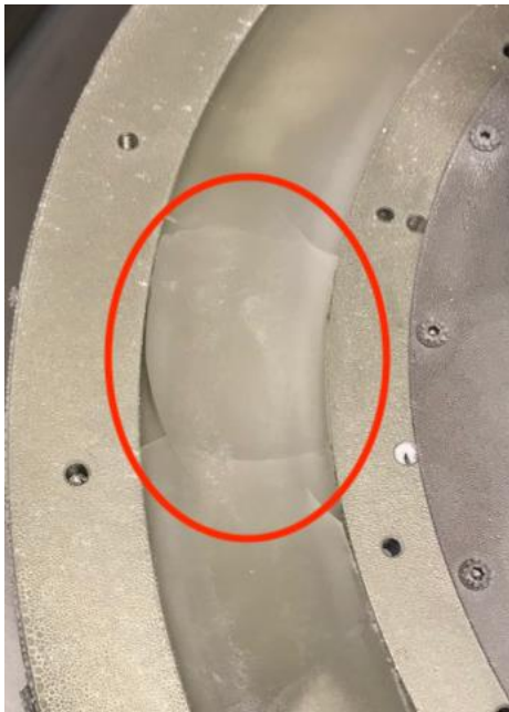
KUVA 12. Jäässä näkyvät (ympyröity) halkeamat, jotka johtuvat liian nopeasta jäädytyksestä.
