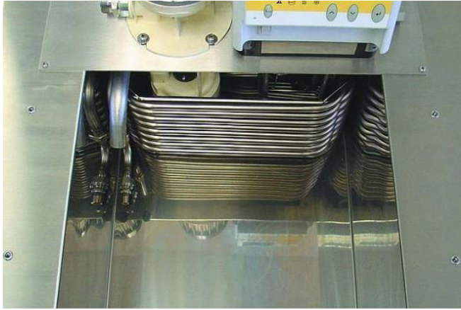
KUVA 9. Jäähdytysjärjestelmän pumppu ja jäähdytysysteemi sisältä kuvattuna. Kylpy täytettiin polydimetyylisiloksaanilla.
