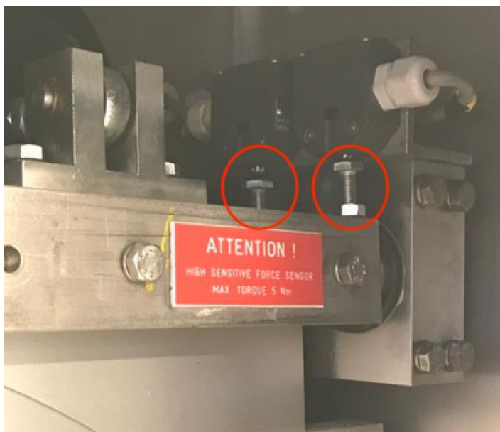
KUVA 15. Metallilevyn etäisyyden jäädytyskiekosta määrittävät sensorit sekä niiden ruuvit (ympyröity).
