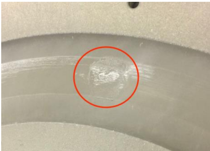
KUVA 17. Jäähän muodostunut epätasaisuus kumikiekosta. Normaalilla jäädytysmenetelmällä valmistettu jää.
