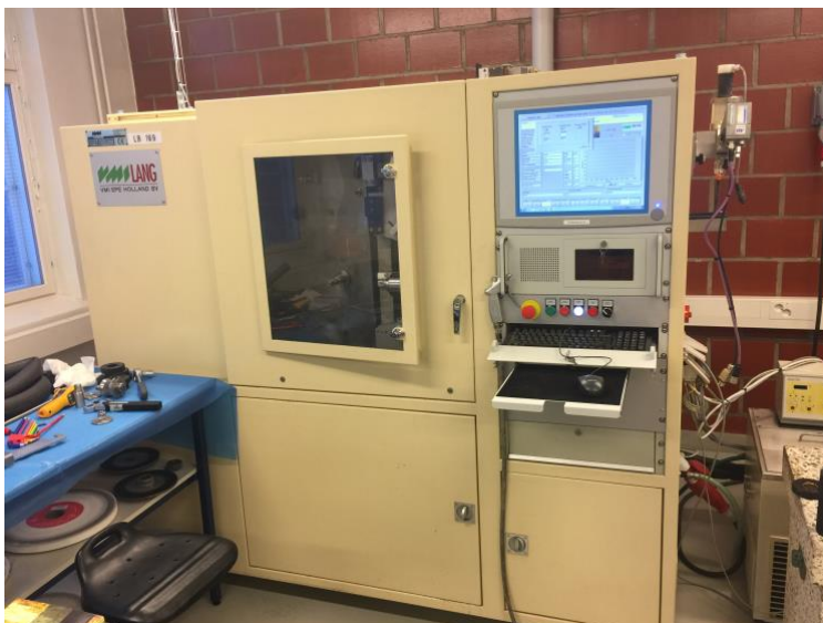
KUVA 4. Laboratory Abrasion and Skid Tester eli LAT100 -laite.
