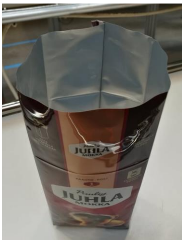
Kuva 5. Pakkauslaitteen muodostama aihio, johon kahvi pakataan. Paketin yläpää ei ole vielä saumattu.
