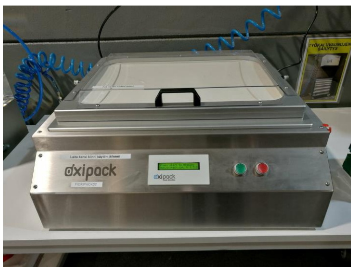
Kuva 11. Stationary Leak Tester Softpack -laite. Laitteella selvitetään, vuotaako pakkaus muodostamalla vakuumi kaasua sisältävän pakkauksen ympärille.
