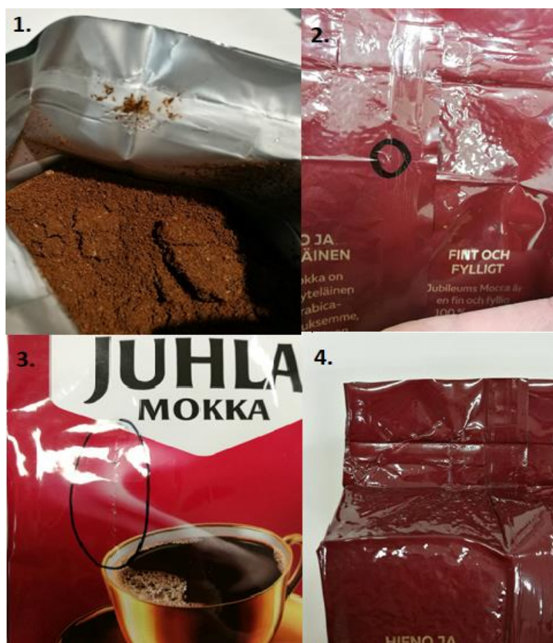
Kuva 6. Esimerkkejä vuotosyistä. 1. Kahvia on jäänyt yläsauman väliin. 2. Paketissa on pistoreikä. 3. Paketissa on pieni nirhauma. 4. Paketin yläsaumaan on muodostunut rypyt.
