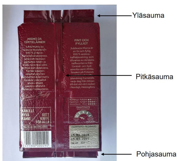
Kuva 9. Kahvipaketin ulkonäön tarkistuksessa kiinnitetään huomiota yläsauman, pitkäsauman ja pohjasauman eheyteen. Kuvassa on osoitettu kyseiset saumat.
