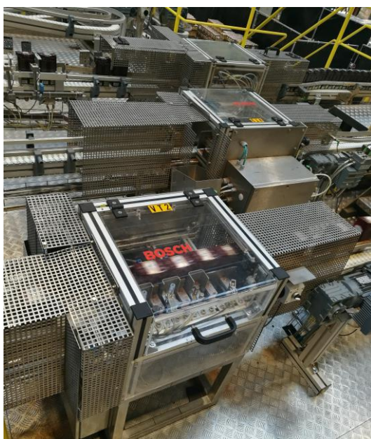
Kuva 7. Kovankoettajalaitteistot ovat sijoitettu pakkauskoneiden jälkeisille kuljetuslinjastoille. Kuvassa näkyy pakkauskoneiden K2–K4 kovankoettajat.
