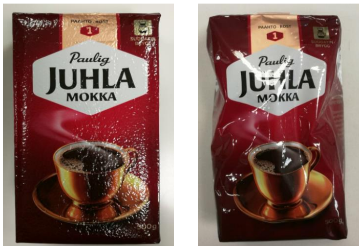
Kuva 2. Oikealla kuva monikerroslaminaattiin pakatusta ehjästä kahvipaketista. Vasemmalla kuva pehmentyneestä ja muotonsa menettäneestä vuotavasta kahvipaketista.
