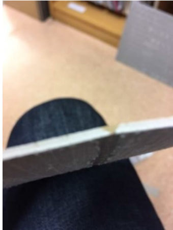
Kuva 8. Oikein suoritetun mattosauman poikkileikkaus.
