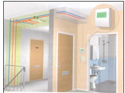
Kuva 16. Huoneistoon asennettavasta huoneistokohtaisesta vedenmittausjärjestelmästä malli [8, s.110].
