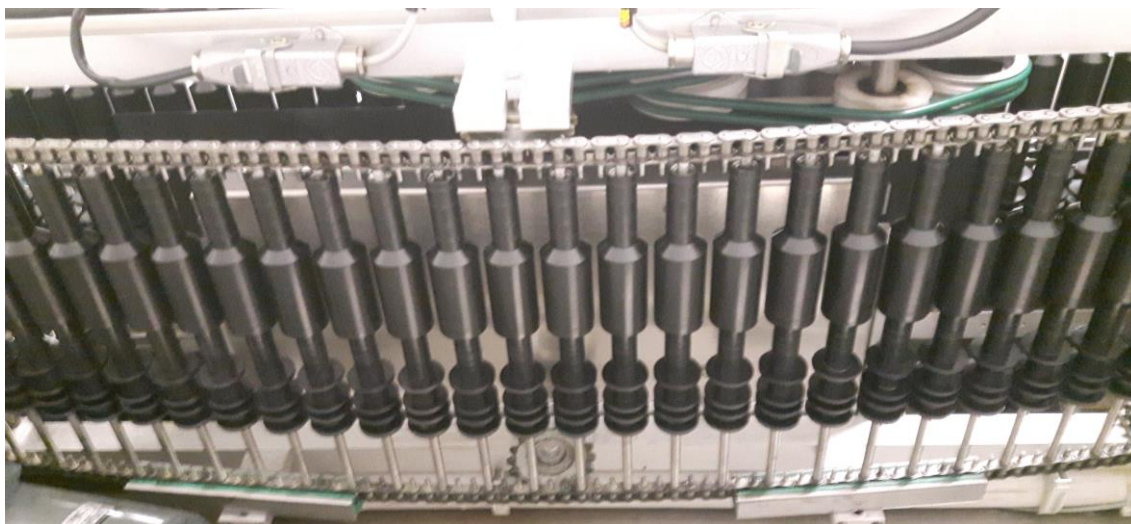
Kuva 2. Seidenader V90/60 LR puoliautomaattisen tarkastuskoneen kuljetusradan rullat. Kuljetusradalla yksiköt ovat rullien päällä. Rullat kuljettavat yksiköt tarkastusalueelle, jossa rullat pyörivät säädettävällä nopeudella. Pyörivät rullat pyörittävät yksiköitä akselinsa ympäri, jolloin yksiköissä oleva liuos saadaan liikkeeseen.
