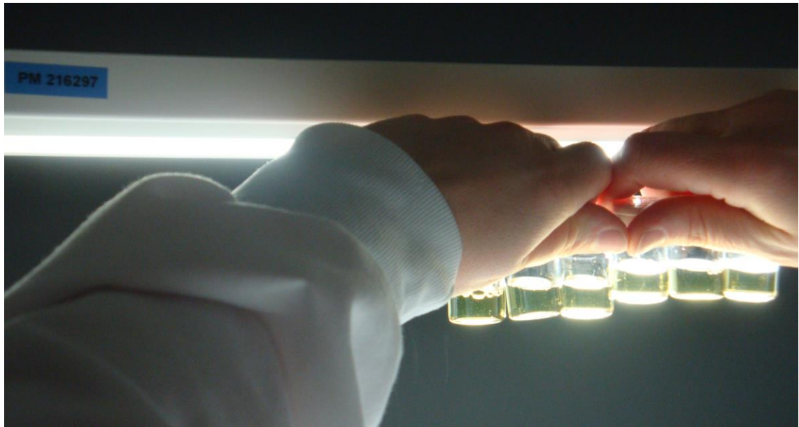
Kuva 2. Elatusaineella täytettyjen yksiköiden visuaalista tarkastamista manuaalisesti.
