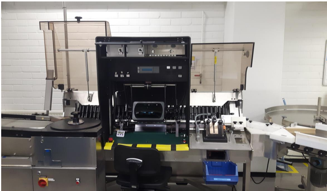
Kuva 1. Seidenader V90/60 LR puoliautomaattinen tarkastuskone suojuukset avattuina. Kuvassa vasemmalla yksiköiden syöttöalue, keskellä tarkastusalue ja oikealla yksiköiden las-tausalue.
