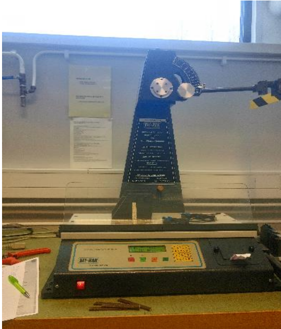
Kuva 12. Iskulujuuskokeessa käytetty RAY-RAN merkinen iskulujuustestauslaite.
