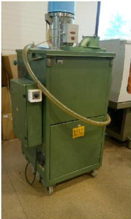
Kuva 7. Opinnäytetyössä materiaalin kuivaukseen käytetty saksalainen GERGO-Appatatebau GmbH & Co, KG Type GTT-201-kuivuri.
