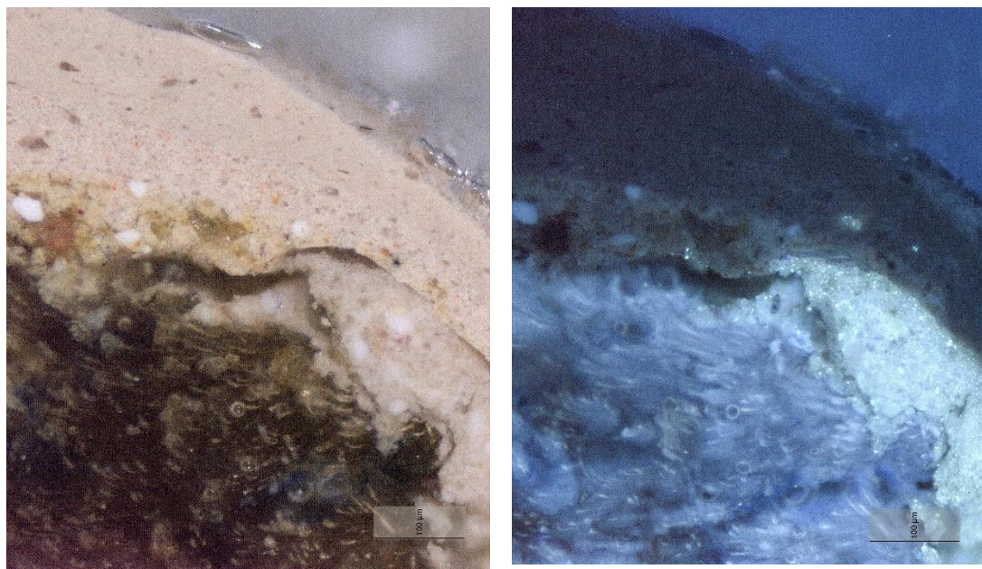
Kuvio 17. Vasemmalla ateljeen ruskean säkkikangastapetin poikkileikkausnäytteen mikroskooppikuva 100 kertaisella suurennoksella ja oikealla UV-valossa.
