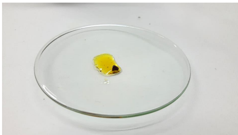
Kuvio 20. Kaliumjodidi-testi salin maalinäytteelle, jossa tärkkelys on värjäytynyt mustaksi.
