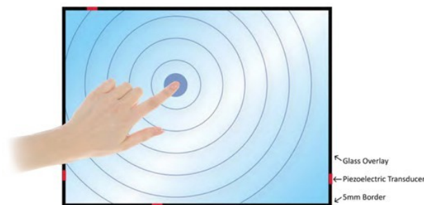
Kuva 18. Acoustic pulse recognition technology (TouchSystems Corporation 2016 D).
