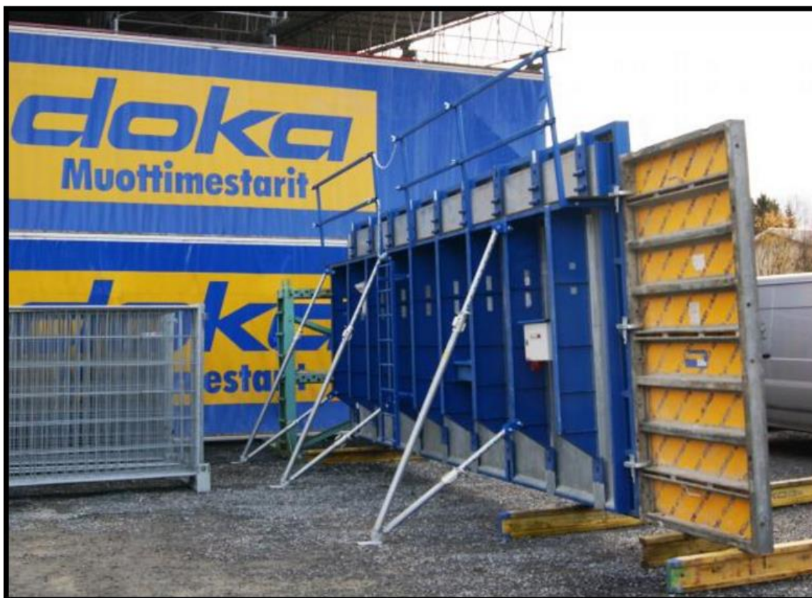
Kuva 16. Dokan sähkölämmitteinen suurmuotti Xlife, joka on liitettynä Dokan Frami Xlife-järjestelmämuotin kasettiin. [12]
