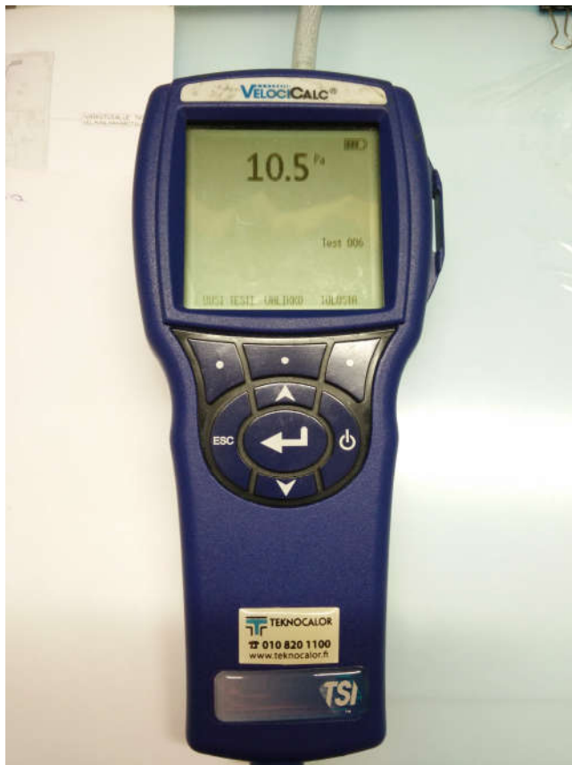
Kuva 12. Mittauksissa käytetty TSI TC9565 – mittalaite.
