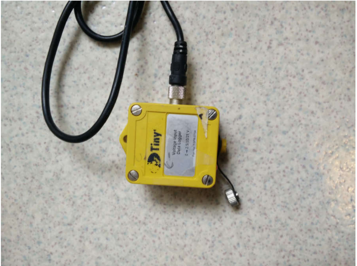
Kuva 20. Tallentava tiedonkeräin seuraa mittalaitteelta tulevaa jänniteviestiä joka sisältää mittaustiedon. Tieto tallentuu laitteeseen ja tuloksia voidaan jälkikäteen analysoida tietokoneella.
