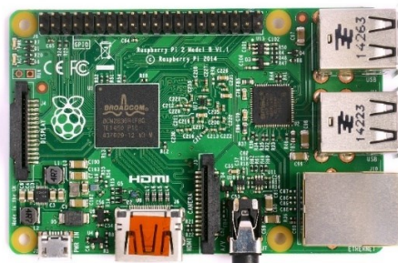
Kuva 1. Työssä käytettiin Raspberry Pi -tietokoneen version 2 mallia B, joka julkaistiin vuonna 2015 (Raspberry Pi Foundation 2018).
