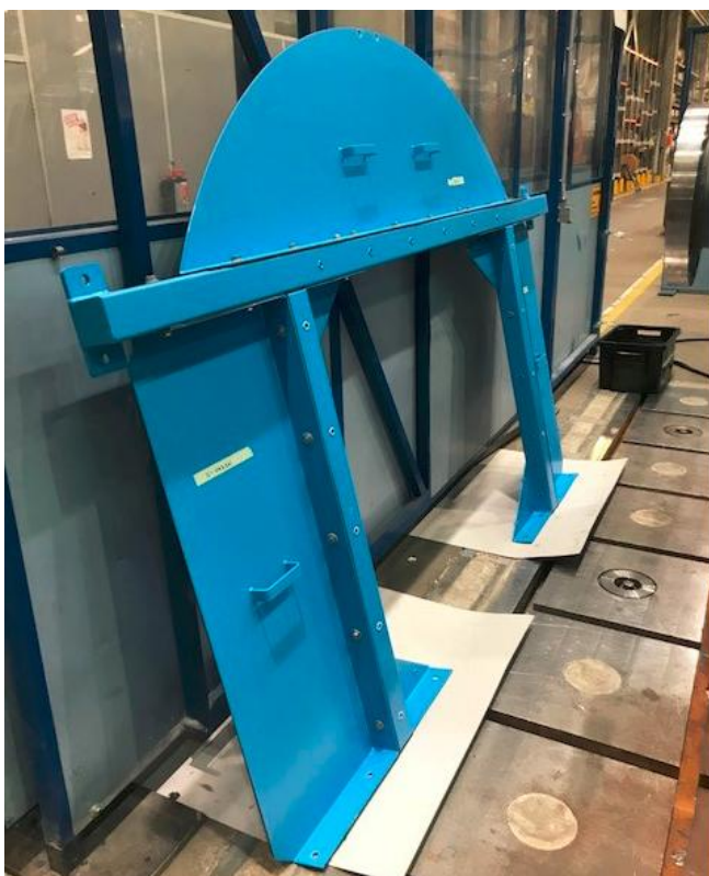
Kuva 15. Ohutlevyjen ja palkin esikasaus suoritettu ABB:llä.
