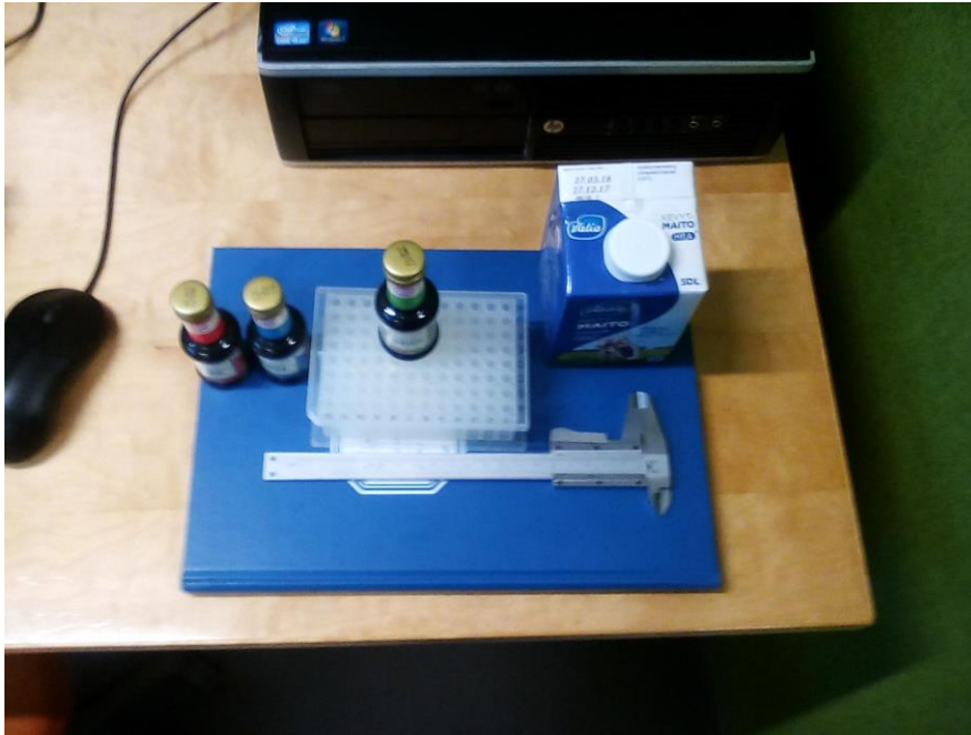
Kuva 16. Kuvassa näkyy metallinvärinen mausermittatyökälu, jolla mitattiin 100 \mu\text{l} :n kärjen tarkat mitat kalibroinnin yhteydessä. Elintarvikevärejä joita käytettiin väritestissä kontaminaatio riskiä selvittäessä vasemmalta oikealle punainen, sininen ja vihreä. Valion kevyt HYLÄ maitoa käytettiin pipetointitesteissä pipetointinopeuden säätöä varten.
