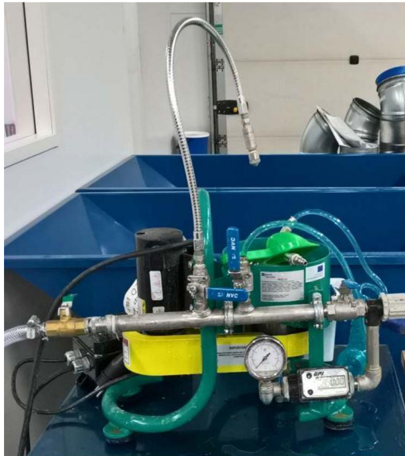
Kuva 4. Lapin AMK:n laboratoriossa sijaitseva Knelsonin separaattori (Optim-laboratorio).
