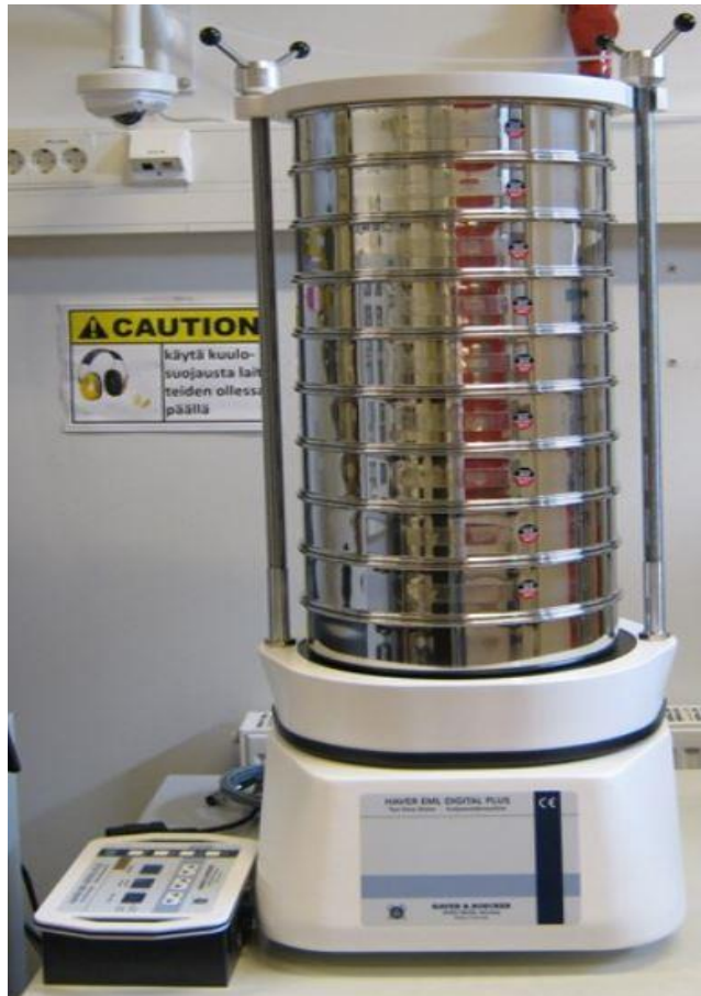
Kuva 3. Lapin AMK:n Haver&Boecker EML315- tärylaite (Optim-laboratorio).
