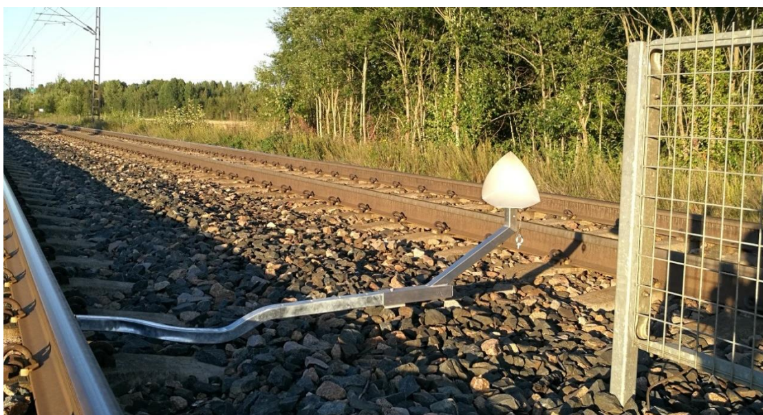
Kuva 11. Kulmaheijastin asennettuna tulokynnykselle. (Holopainen 2017)
