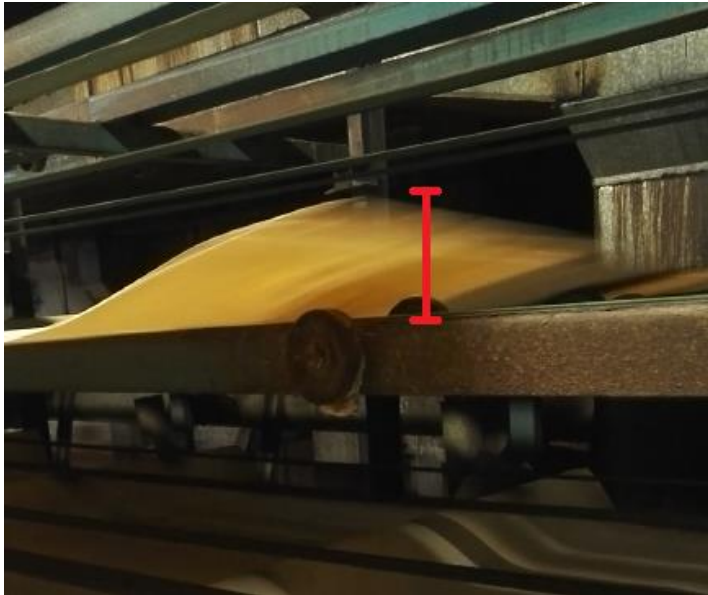
Kuva 10. Viilumaton pää noussut selvästi ilmaan osuessaan apupyöriin. (Kuva: Jarno Mutanen).
