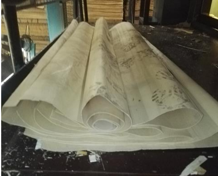
Kuva 8. Poistettu ruuhka kuivauskoneen alimmasta kaarteesta. (Kuva: Jarno Mutanen).
