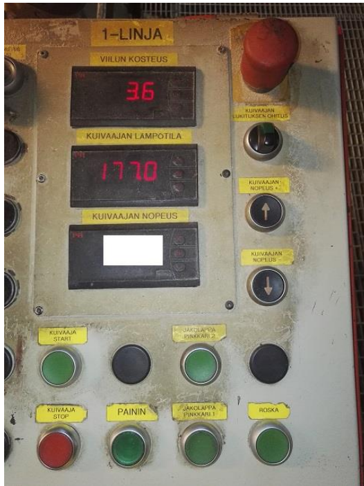
Kuva 1. 1-kuivauskoneen säätö- ja näyttöpaneeli. (Kuva: Jarno Mutanen).
