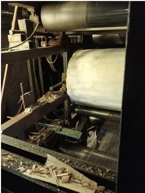
Kuva 12. Viilumatto osuu kuivaajan runkoon alimmassa kaarteessa. (Kuva: Jarno Mutanen).
