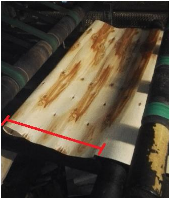
Kuva 9. Viilumatto kaksin kerroin kerroskuljettimen jälkeen. (Kuva: Jarno Mutanen).
