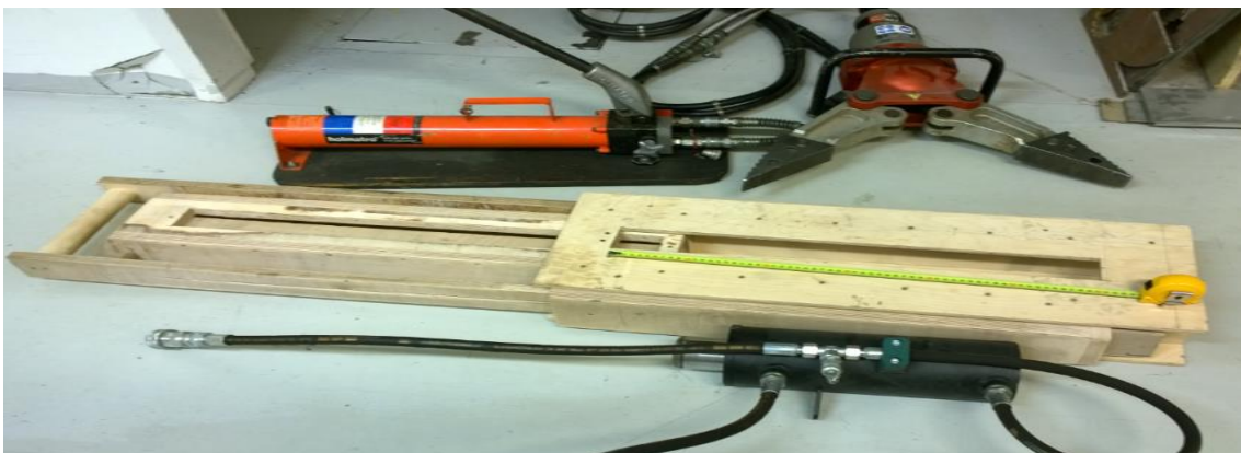
KUVA 9. Vaneriprototyyppi testattavana. Vaneriprototyypin vieressä on 100 mm sylinteri, jonka iskunpituus on 200 mm.
