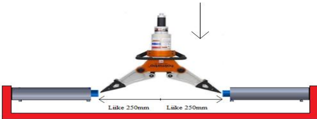
KUVA 5. Kahden vastakkaisen sylinterin malli. Leuat avautuvat symmetrisesti, levitin laskeutuu testin aikana.
