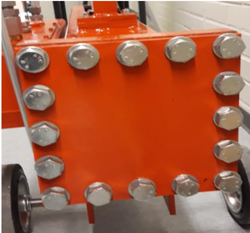
KUVA 14. Päätylaippa jota pitää kiinni on 16 kpl M16 m8.8 pultteja
