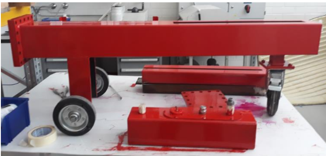
KUVA 12. Öljysäiliö, runko, päätylevy ja kelkka
