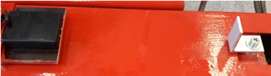
KUVA 27. Laseretäisyysanturi kotelossa ja heijastava vaste
