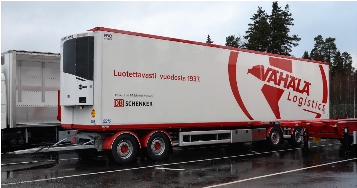
Kuva 2. VAK Oy:n valmistama perävaunu koneellisesti jäähdytetyllä kuormatilalla
