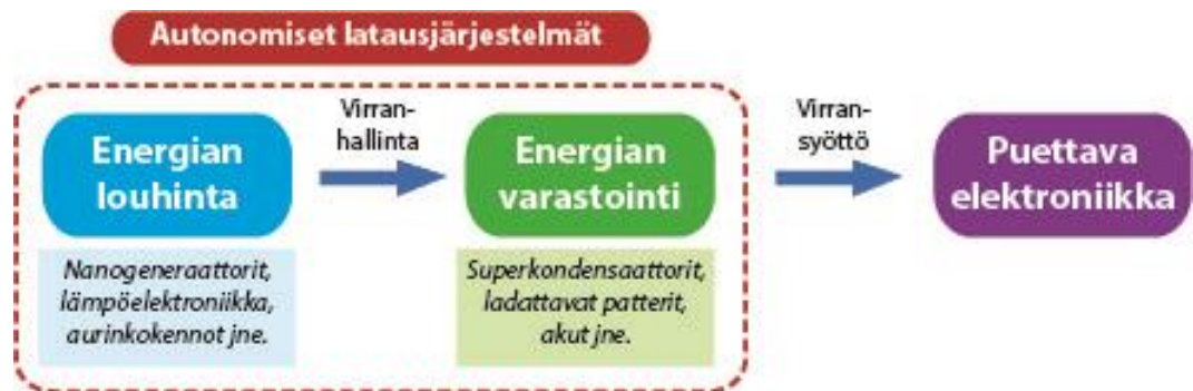
Kuvio 6. Autonomisten energian latausjärjestelmien toiminta (Small 2018, suomennettu)
