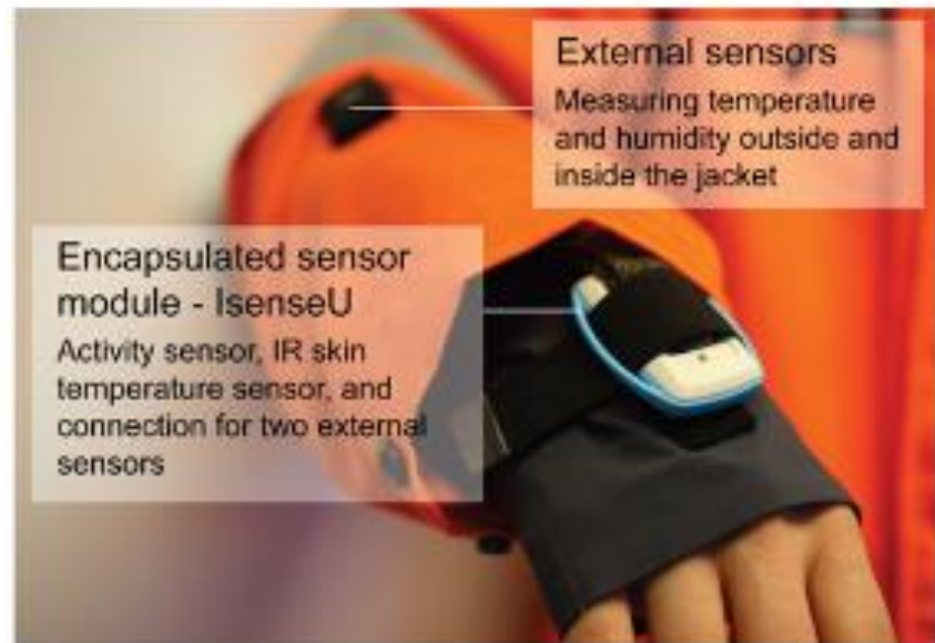
kuva 17. Coldwear-projektin takin hihasensorit (Seeberg yms. 2013)
