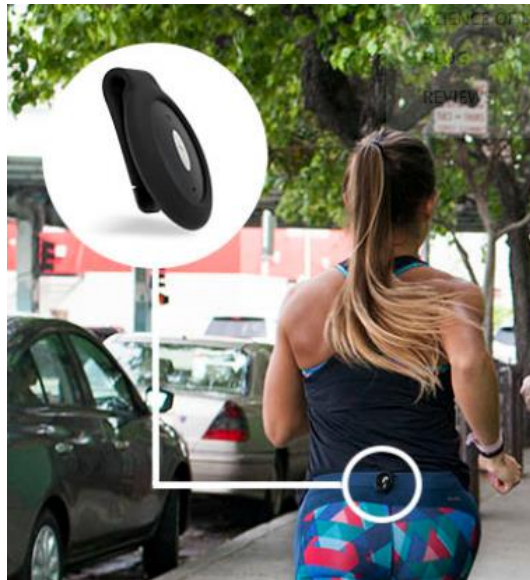
Kuva 6. Lumo Run:n puettava sensori kiinnitetään takavyötärölle
