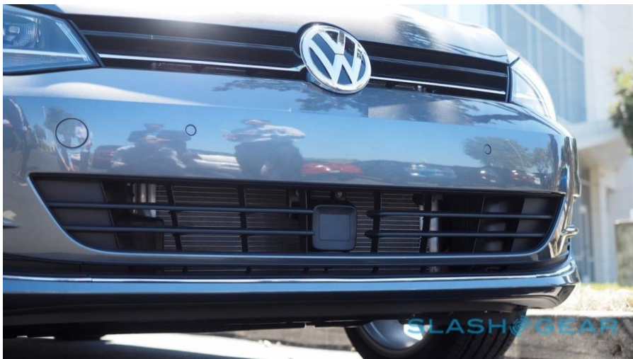
Kuva 2. Tutkatunnistin sijoitettuna ajoneuvon etupuskuriin [4].
