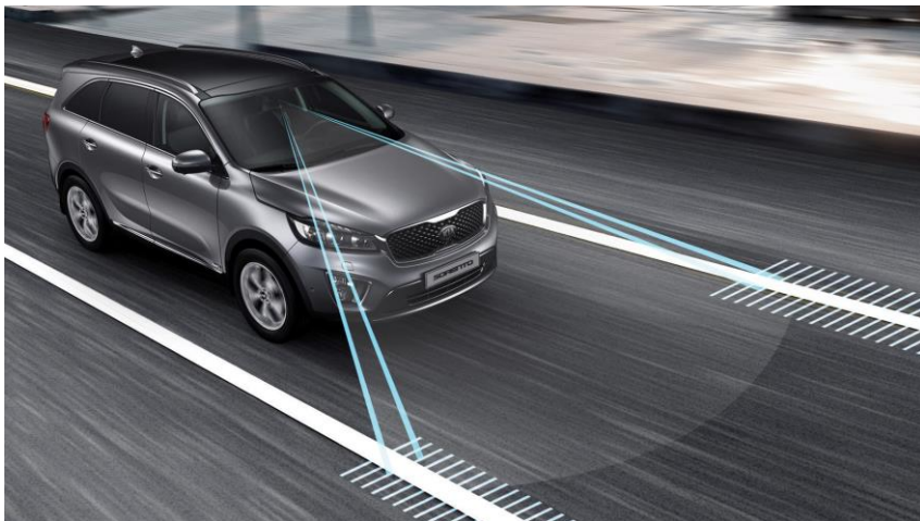
Kuva 3. Kameran toiminta kaista-avustinjärjestelmässä [5].
