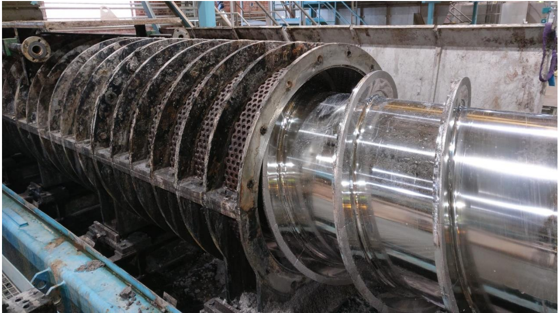
Kuvio 11. Ruuvipuristimen rakenne.
