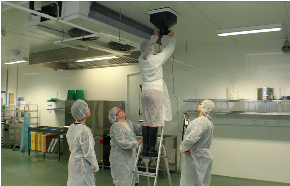
Kuva 2. Opiskelijaryhmä tarkastelemassa ilmanvaihtoa Testo 435-4 Climatetester -laitteella Kapyysissa (kuva Juba Palmu, Kymijoen Ravintopalvelut Oy).
