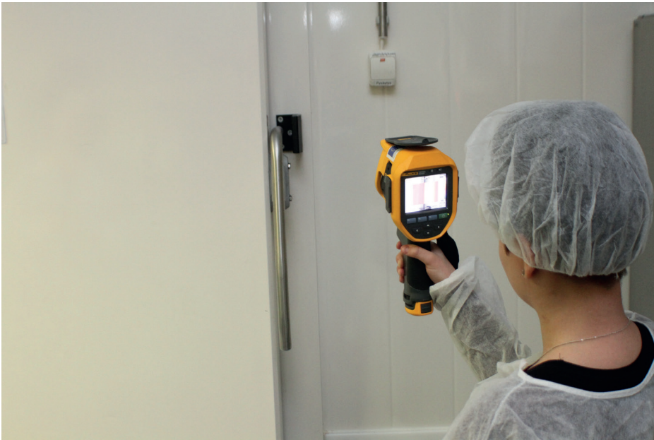
Kuva 3. Pakastimen tiiviyyden tarkastelua Fluke Ti300 –lämpökameralla Kapuysissa (kuva Juha Palmu, Kymijoen Ravintopalvelut Oy).
