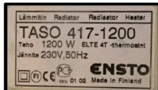
Kuva 5. Sähkölaitteen merkin ja mallin kirjaaminen on tärkeää myös muiden vastaavien palojen tutkimisessa
