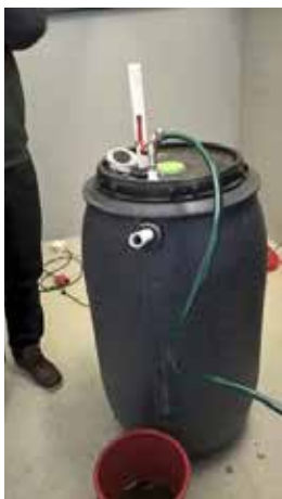
Kuva 15. Täyteen ladattu ja eristetty reaktori, johon on yhdistetty lämpötilamittari (kuva: Kari Laasasenaho).
