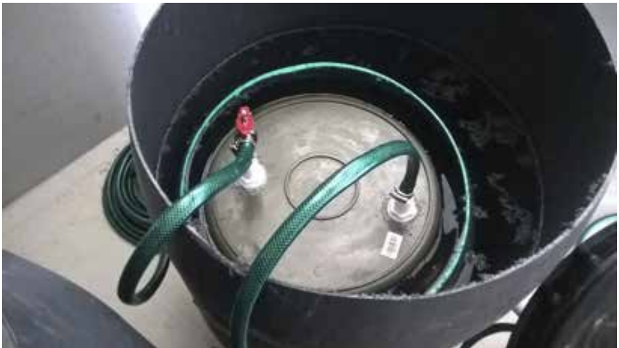
Kuva 13. Jos muoviämpäri menee vinoon, ylimääräinen tuki voidaan asentaa isomman tynnyrin sivuille (kuva: Kari Laasasenaho).
