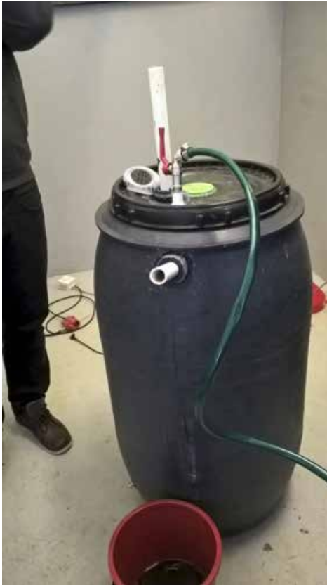
Kuva 5. Muovireaktori, jossa kaasunkeräys on rakennettu toiseen tynnyriin (rakennettavissa tämän kirjan ohjeilla, kuva: Kari Laasasenaho).
