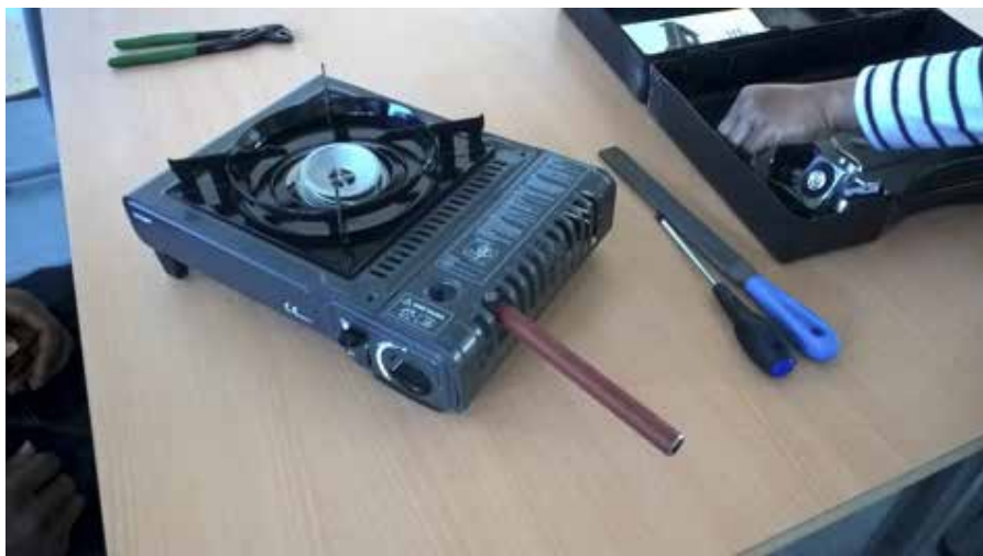
Kuva 6. Biokaasukeittimeksi muunnettu nestekaasukeitin. Punainen putki on tarkoitettu biokaasun syötölle (kuva: Kari Laasasaho).
