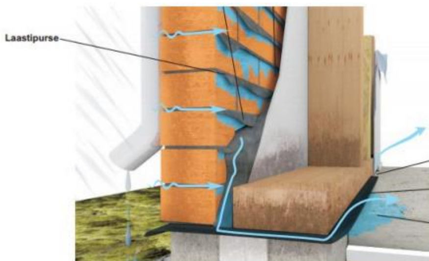
Kuva 11. Tiiliverhoiltu puurunkoinen seinä ja siinä ilmenevät ongelmat. (Kosteus- ja hometalkoot www- sivut , 2012)
