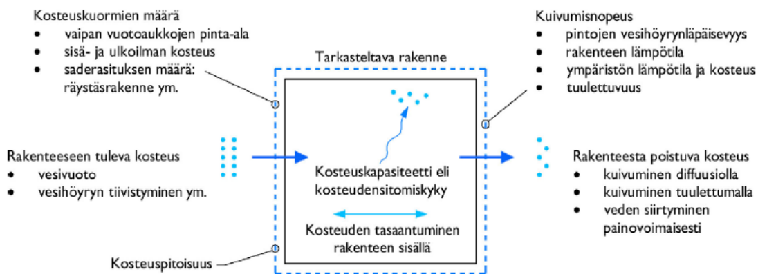
Kuva 7. Rakenteiden kosteusvaurioitumisen yleisperiaate. (Siikanen 2014, 149)
