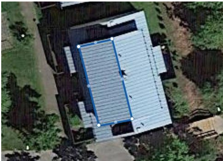
Kuva 12. Paneeleille soveltuvan kattopinta-alan määrittäminen Vattenfallin internet-työkalulla.
