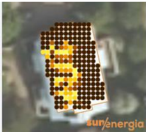
Kuva 11. Aurinkopaneeleille parhaiten soveltuvat kohdat esimerkkikiinteistön katolla. Mitä vaaleampi väri, sitä parempi sijainti. (Sun Energia)
