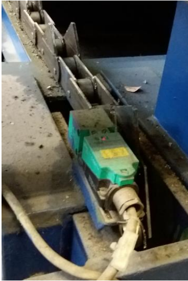
KUVA 1. Billettivarastossa käytetty induktiivinen anturi
