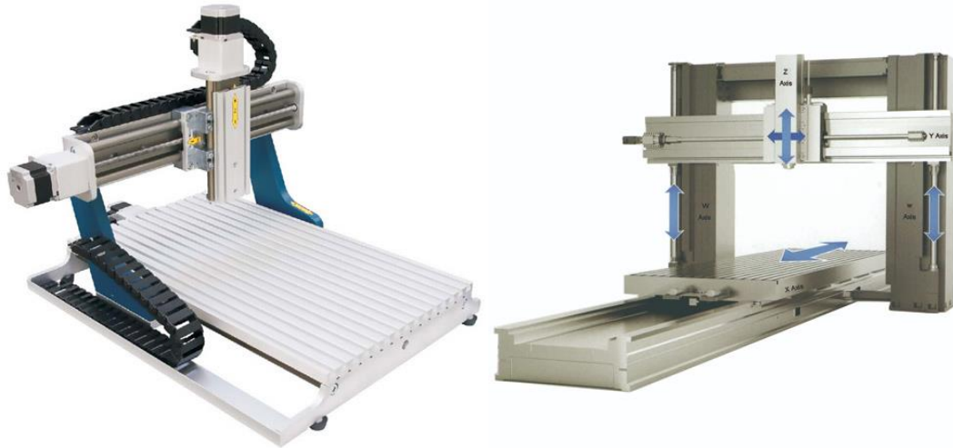
Kuva 10. Liikkuva portaali ja liikkuvat työstöpöytäkoneet (13)
