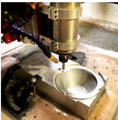
Kuva 6. Sumutin, joka sekä poistaa lastuja että voitelee terää (81)
