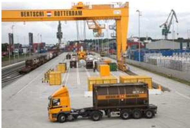
KUVIO 18. Yhdistettyjen kuljetusten terminaalissa oleva RMG-nosturi (New intermodal Bertschi-terminal in the port of Rotterdam 2007).
