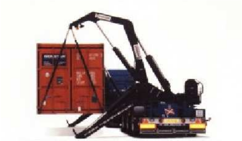
KUVIO 21. Irtooperaavaunuun sijoitettu sivulastaaja, sideloader (160-series brochure N.D.).
