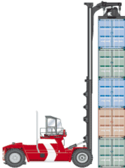
KUVIO 20. Kuormattujen konttein käsittelyyn sopiva vastapainotrukki (Loaded container handlers N.D.).
