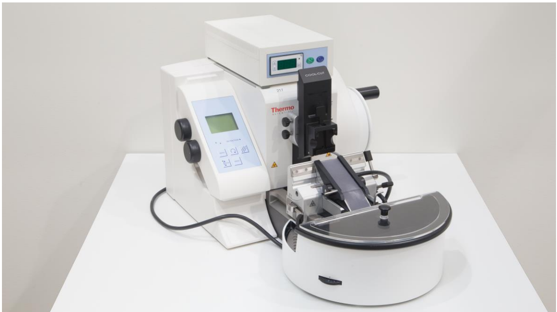
KUVA 3. Rotaatiomikrotomi Thermo Scientific HM340E ja Microtom STS-vesihaude (Kuva: Stålhane 2018)
