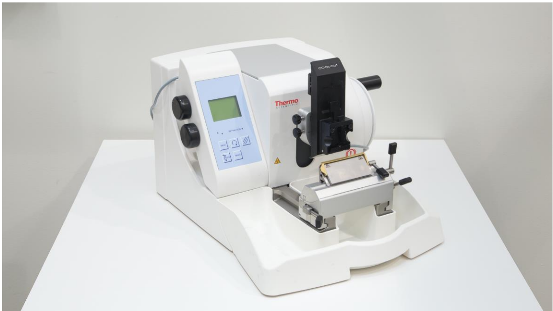
KUVA 2. Rotaatiomikrotomi Thermo Scientific Microtom HM340E (Kuva: Stålhane 2018)
