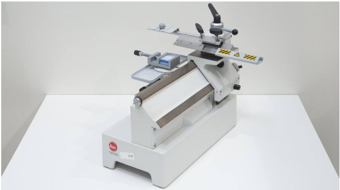
KUVA 1. Liukumikrotomi Sledge Microtome LEITZ 1208 (Kuva: Stålhane 2018)
