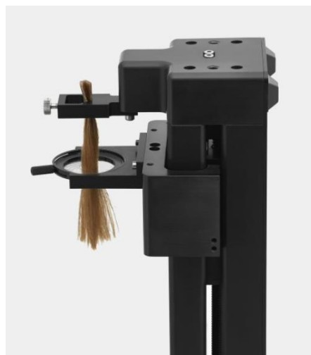
Kuvio 25: Hiusten volyyymia mittaava MTT175 Miniature Tensile Tester sivusta päin (allbiz 2018)
