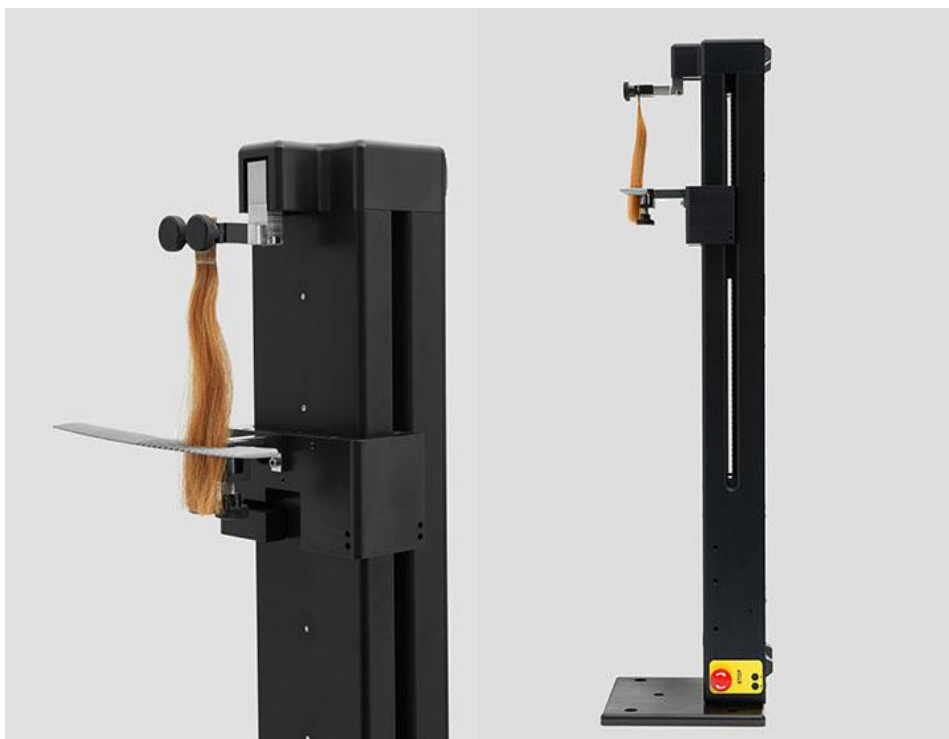
Kuvio 3: Kammattavuutta mittaava Dia-Stron Miniature Tensile Tester (Dpro Scientific 2018)
