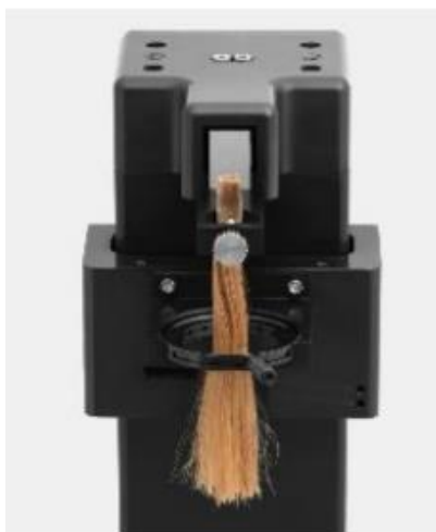
Kuvio 26: MTT175 Miniature Tensile Tester muokattuna hiusten volyymin mittaukseen (Dia-Stron 2018)
