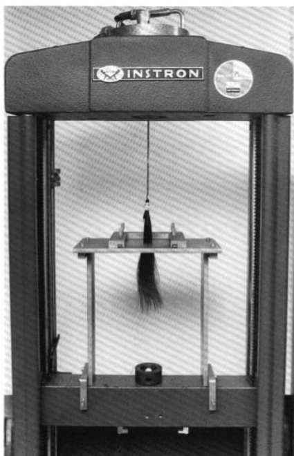
Kuvio 28: Instron Tensile Tester muokattuna hiusten volyymin mittaamiseen (Robbins & Crawford 1984, 370)
