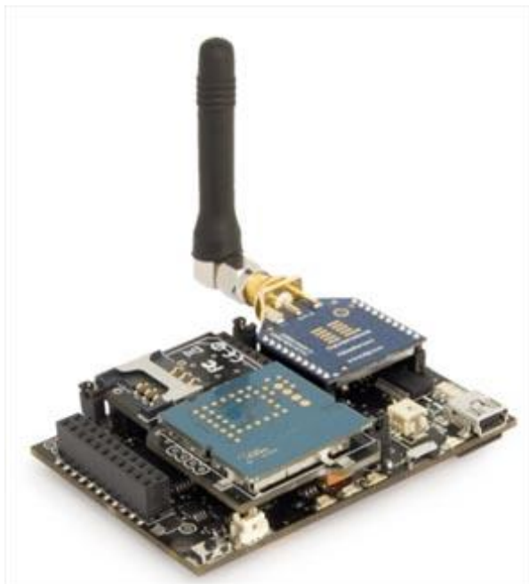
Kuva 5. Waspnote-alusta, johon on asennettu XBee-lähetinvastaanotin ja GSM/GPRS-moduuli.
