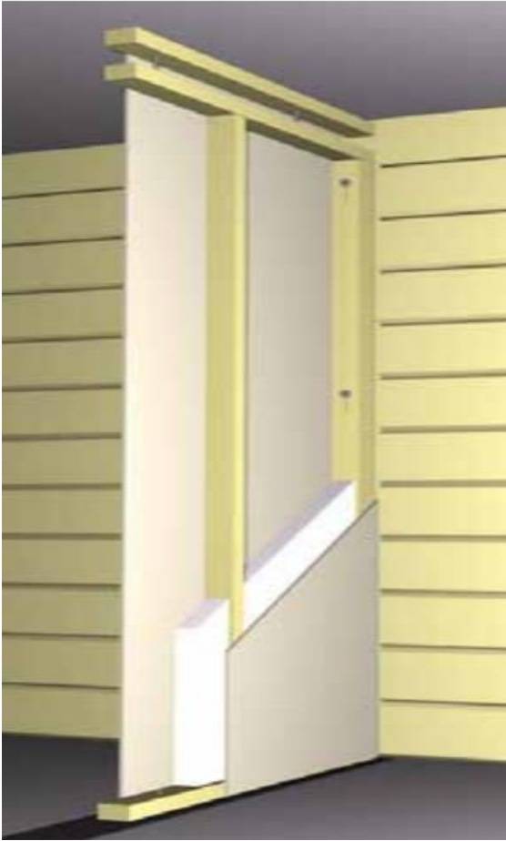
Figur 20. Vanlig lösning till lättmellanväggar (Redigerad: RT Hirsitalon suunnitteluperusteet, 2014)
