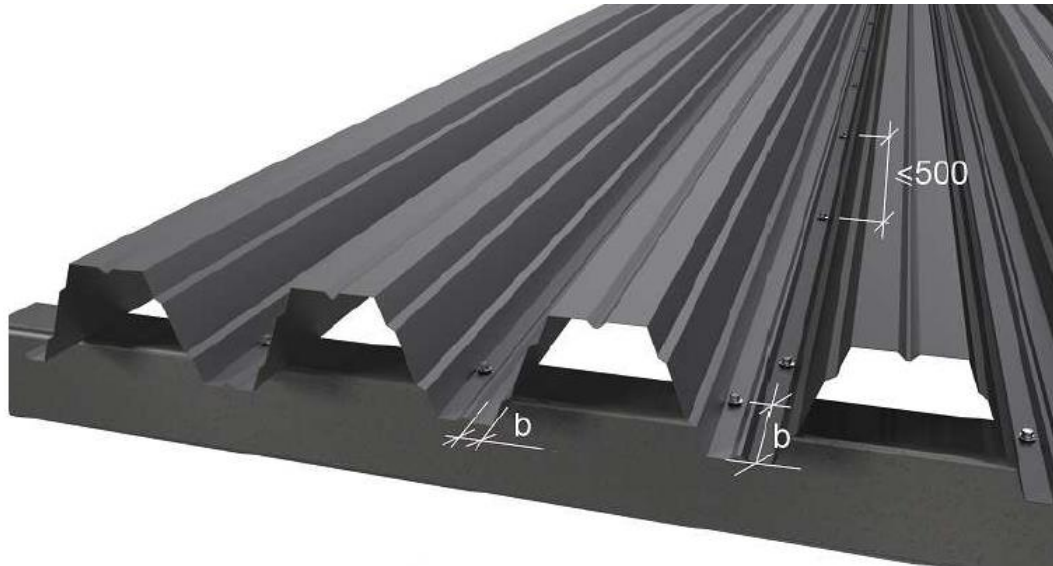
Kuva 14. Poimulevyn kiinnikkeiden paikat eristetyssä katossa. [6.]
