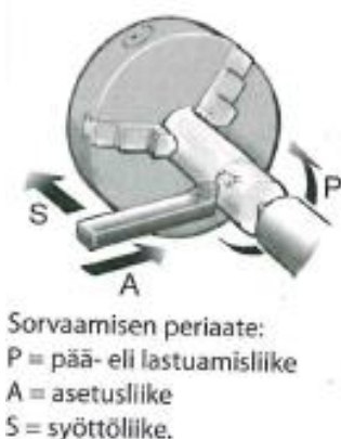
KUVA 2. Sorvauksen periaate (Maaranen 2012, 129.)
