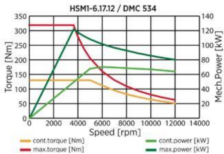
Kuva 30. HSM1-6.17.12-sähkömoottorin teho- ja vääntömomentti (11).
