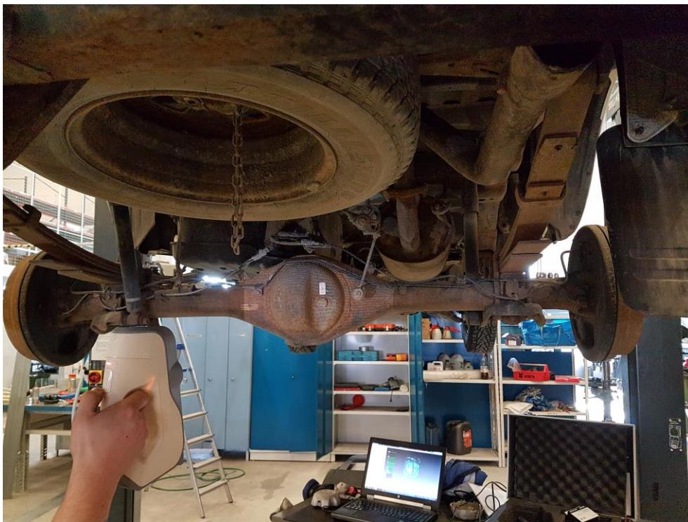
Kuva 11. Toyota Hiluxin taka-akselin 3D-skannaus.
