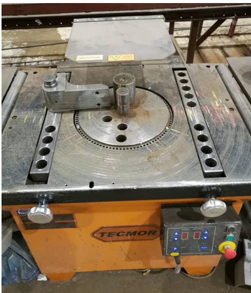
Figur 19. Tecmor Bockningsmaskin. (Björn Kellgren)
