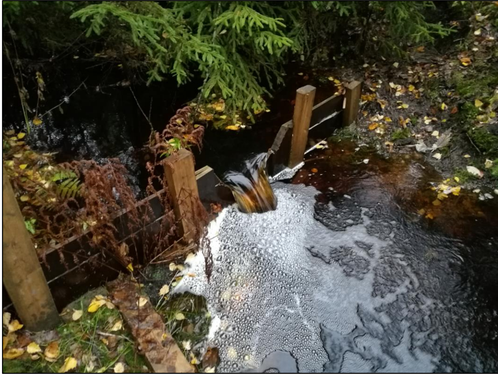
Kuva 7. V-pato asennettuna Noro 1:een (Maarit Luoranen)
