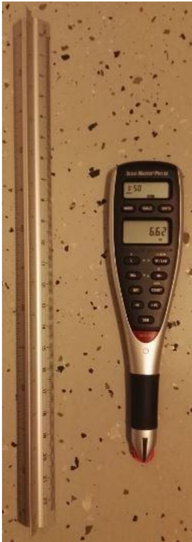
Kuva 2. Mittasuhdeviivain ja rissa. Rissan ylempään näyttöön asetetaan kuvan mittasuhde ja alempi näyttö näyttää mitatun etäisyyden.
