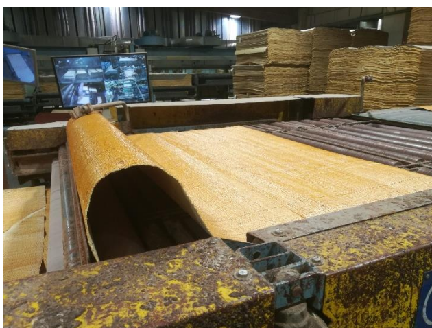
Kuva 12. Ristikkäisviilun tarttuminen vastaanottimen telaan
