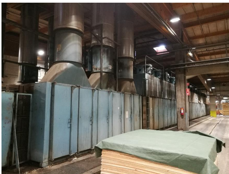
Kuva 5. Telakuivaajan lämmitys- ja jäähdytysyksiköt
