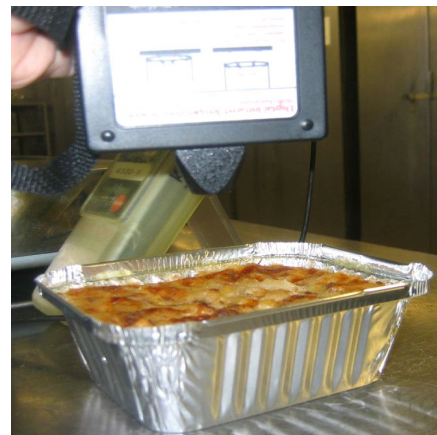
Kuvio 8 B. Laatikon säteilylämpötilan mittaaminen.
