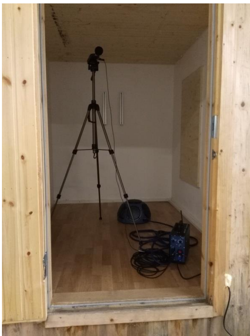
Kuva 18. Ilmaääneneristävyyden mittauksien laitteisto lähettävässä tilaelementissä 2.
