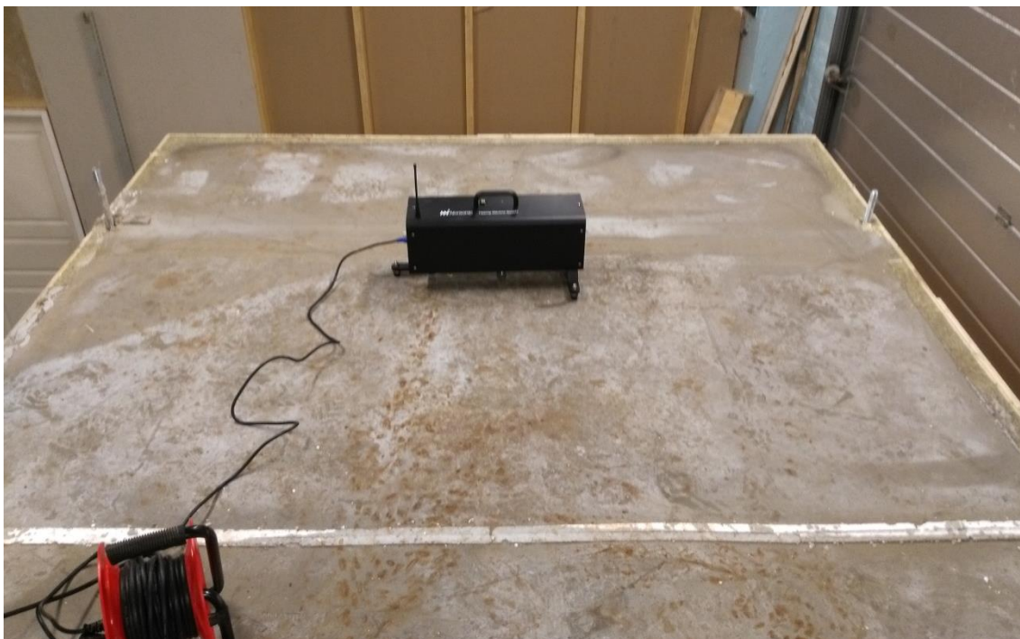
Kuva 19. Askeläänikoje sijaitsi kaikkien mittauskertojen aikana toisen tilaelementin päällä.
