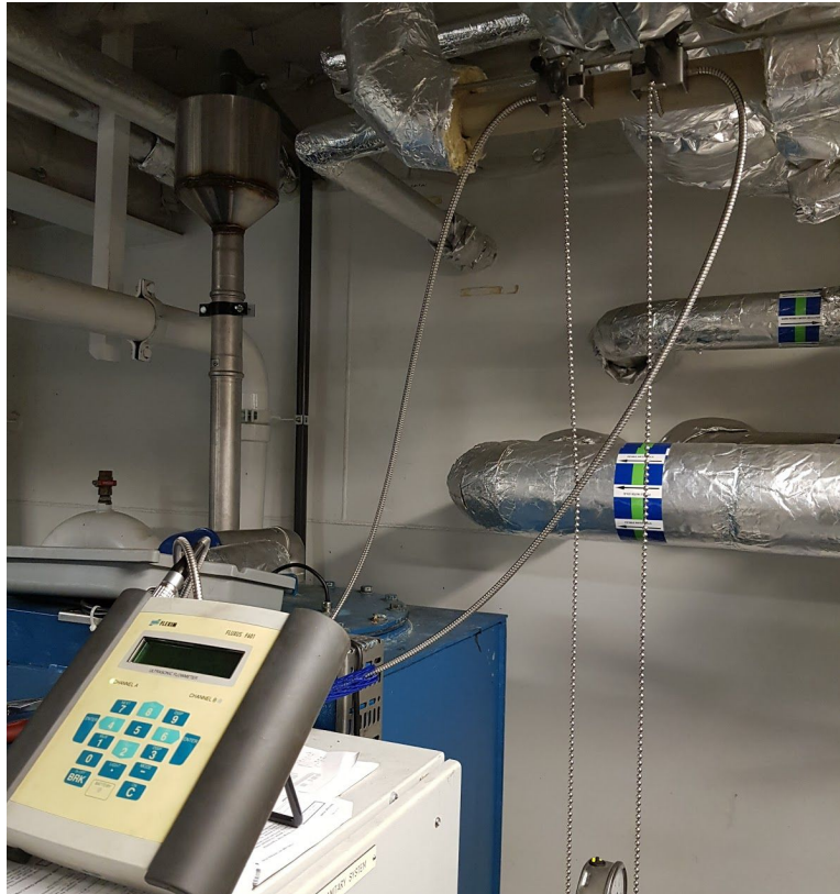
Figur 5. Flödesmätning med hjälp av Flexim Fluxus F601.
