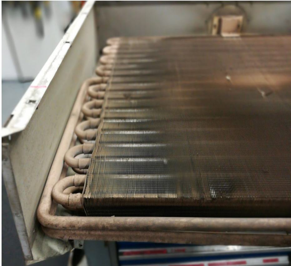
Figur 8. Bild på innanmätet på elementet är rördragningen och värmevlänsarna syns.
