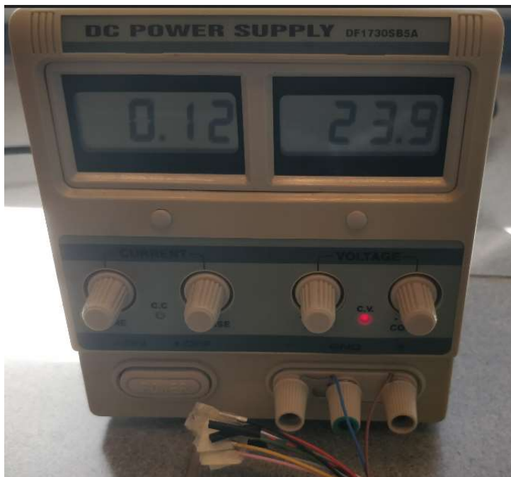
Kuva 12 Johtojen liittäminen teholähteeseen
