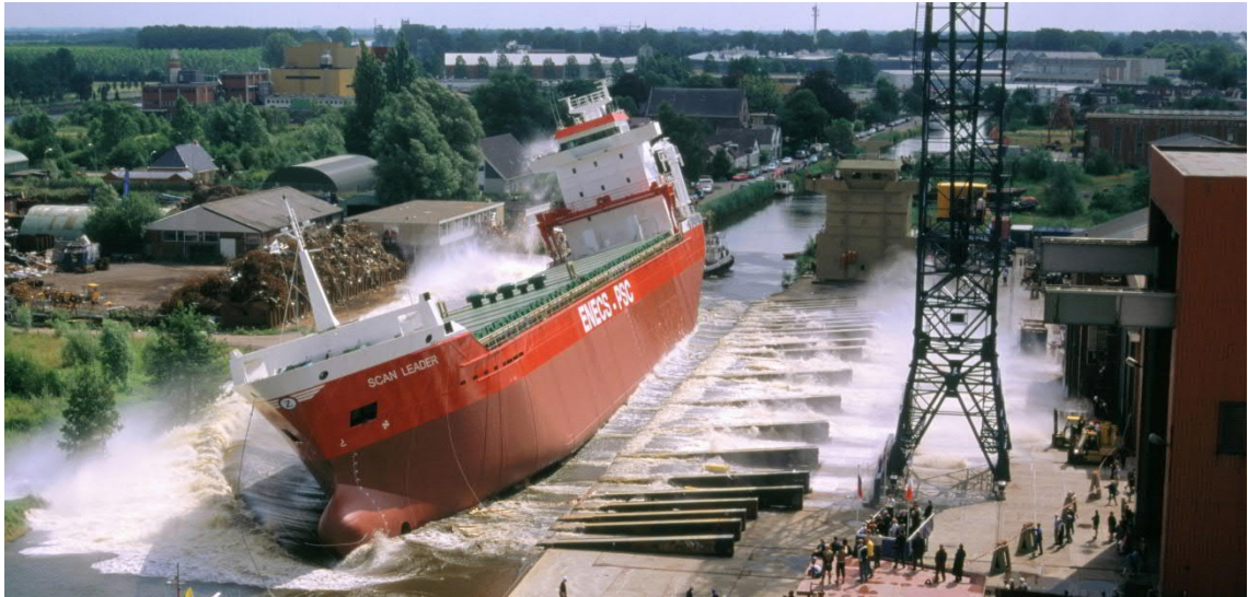
Kuva 8. Poikittaissuunnassa tapahtuva vesillelasku (Hakai 2016).
